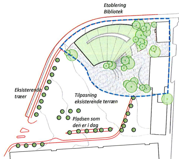
ETAPE 0 Bibliotek med terræn regulering i forhold til biblioteketsfacader og indgange. Tilpasninger til eksisterende plads
